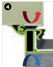
4 Joints latéraux et de linteau EPDM à rupture de pont thermique doublés de joints de compression
