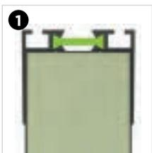
1 Profil haut en aluminium à rupture de pont thermique. Supprime le point de rosée.
