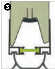
3 Profil bas en aluminium à rupture de pont thermique. Supprime le point de rosée.
