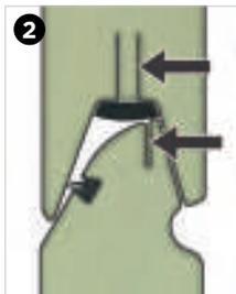
2 Panneaux à rupture de pont thermique composés de 2 tôles d'acier (1 intérieure et 1 extérieure) sans point de contact.
