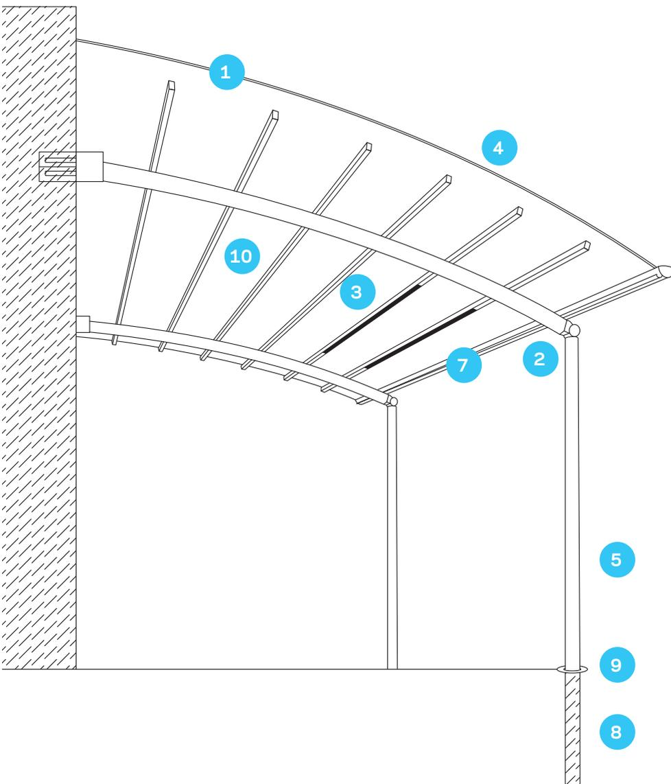
1. Auvent avec panneaux de toit en polycarbonate massif – incassable et jusqu'à 250 fois plus résistant que le verre
